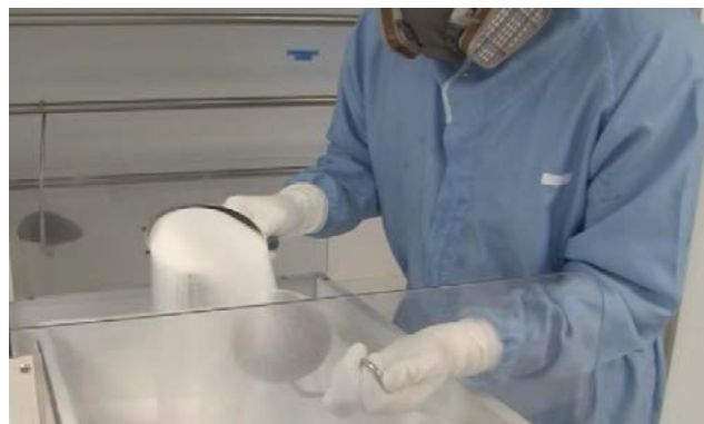
Рис. Соль. Текстуру получают путем нанесения выверенных по размеру кристаллов поваренной соли и последующего их растворения
